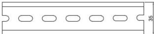
Install rail / 安装轨道: TS35/7.5 or TS35/15
