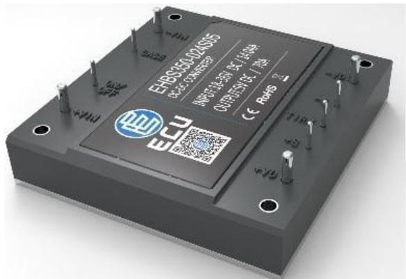
华耀电子的EHBS是标准的1/2砖块尺寸封装的高性能DC-DC模块电源，此系列以宽的输入范围以及高效率，低高度，和高可靠性为主要特点，另外，此模块电源具有较宽的调节范围（90% to 110%）并可以订制特殊输出电压，并且具有并联功能。EHBS系列有着良好的热性能，适用于雷达，通信，轨道交通等军工电子设备的众多应用场合。
