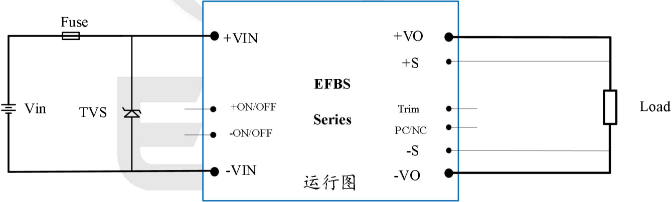
图1，模块运行需要输入电容，建议接入保险丝
