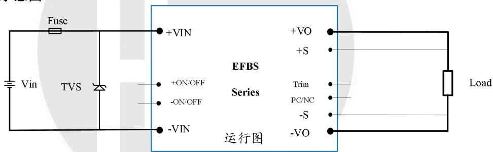
图1，模块运行需要输入电容，建议接入保险丝
