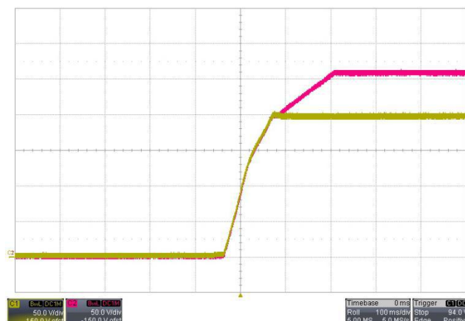
图 6: 满载情况下启机波形: V_{BUCK} (CH1), V_{OUT} (CH2); V_{BUCK} 并联 1mF 电容, V_{OUT} 并联 68uF 电容
