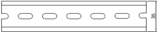
Install rail / 安装轨道: TS35/7.5 or TS35/15
